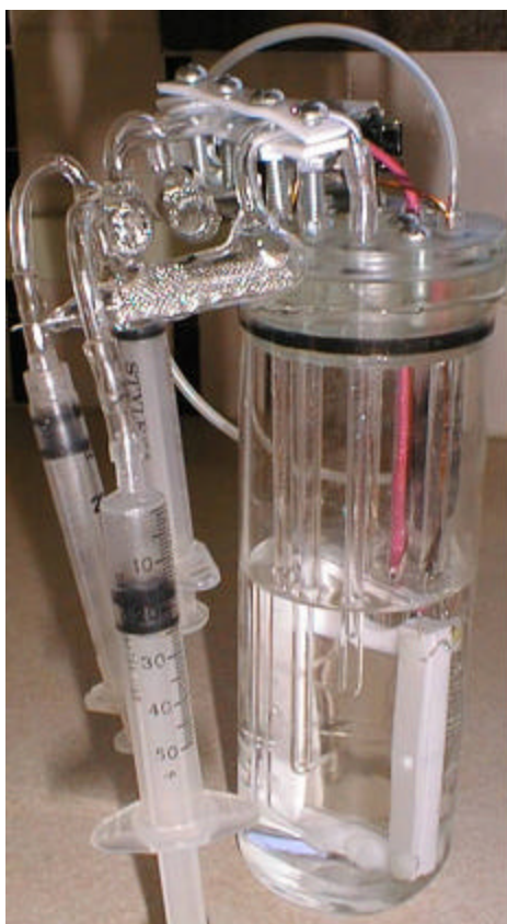
Foto 1b. Cella elettrolitica per fusione fredda, altezza approssimativa 14 cm. (Foto per cortesia di Edmund Storms)
